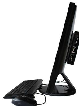
Le Linutop 4 peut être accroché au dos du moniteur grâce à une fixation en option.
